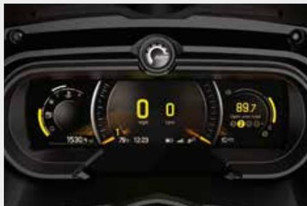
**ЦИФРОВАЯ ПАНЕЛЬ ПРИБОРОВ:** Большой панорамный цветной ЖК-дисплей 7,8" с системой BRP Connect™, обеспечивающей возможность интеграции с оптимизированным для родстера мобильным приложением. Проигрывание медиафайлов, управление навигатором и многими другими функциями с помощью органов управления, расположенных на руле.
